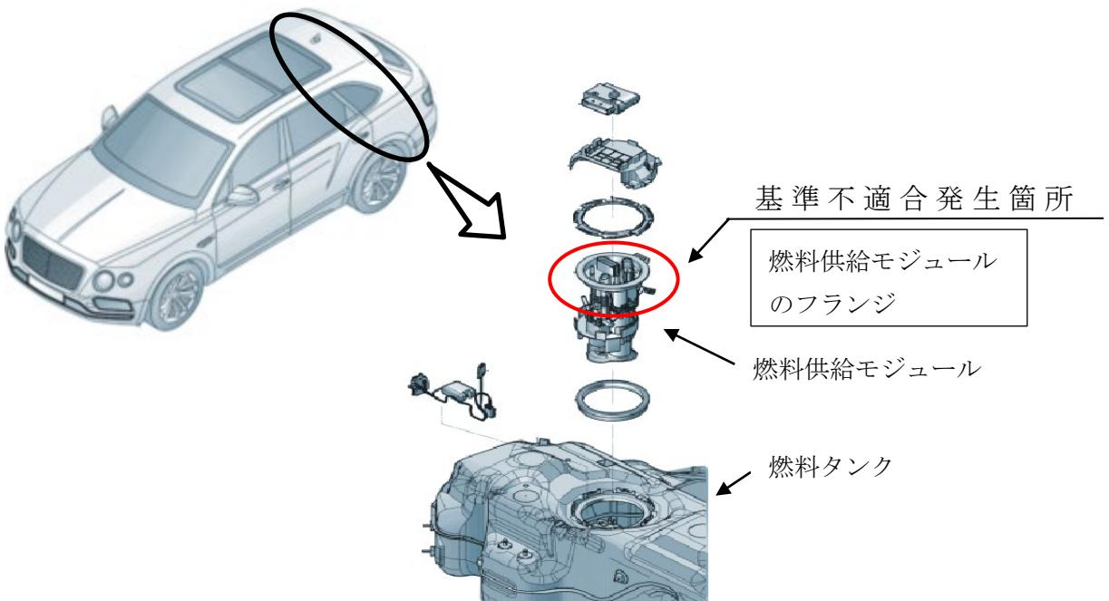
燃料装置の燃料タンクにある燃料供給モジュールにおいて、燃料供給モジュールフランジ部の部品設計が不適切なため、周囲の温度が高く、品質が悪い燃料を使用した際、過剰な電流が流れるとフランジ上部の電気コネクターが過熱し、フランジが溶損することがある。そのため、フランジの溶損箇所から少量の燃料が漏れ、最悪の場合、火災に至るおそれがある。
