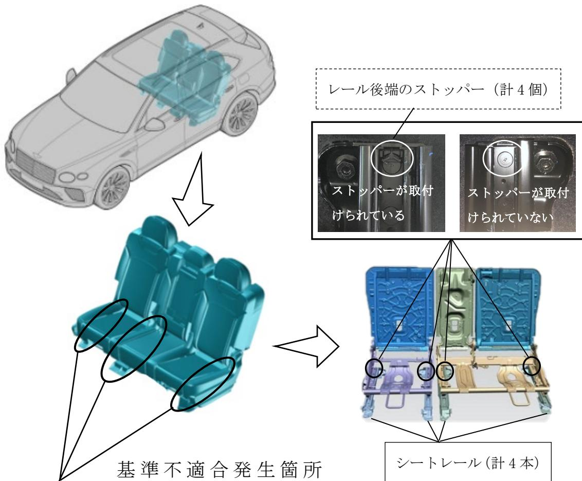
後席のスライド式シートレールにおいて、レールのアライメントが不整合な状態で取付けられ、座席固定溝の位置が僅かにずれているため、座席が確実に固定されていないものがある。そのため、衝突時に座席が動き、最悪の場合、乗員が負傷するおそれがある。また、当該レール後端にストップバーが取付けられていないものがあり、座席を最後位置に移動した場合、カーペットを傷付けることがある。
