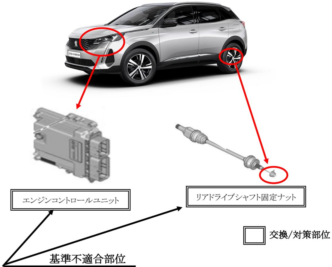
エンジンコントロールユニットのソフトウェア及びリアドライブシャフト固定ナットの締めトルクが不適切なため、特定の走行条件下で開発時の想定を上回るねじり応力がリアドライブシャフトに発生し、リアドライブシャフトが破断するおそれがある。このため、異音の発生とともに警告灯が点灯するおそれがある。
