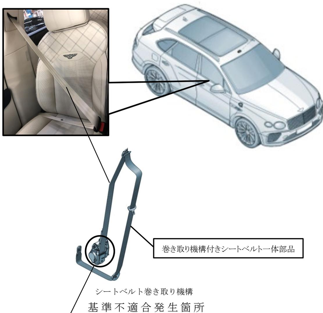
助手席シートベルトの巻き取り機構において、一部構成部品の寸法評価が不適切なため、チャイルドシート用ロック機能が正しく作動しないものがある。そのため、車両衝突時にチャイルドシートを適切に拘束することができず、最悪の場合、チャイルドシートの乗員が負傷するおそれがある。
